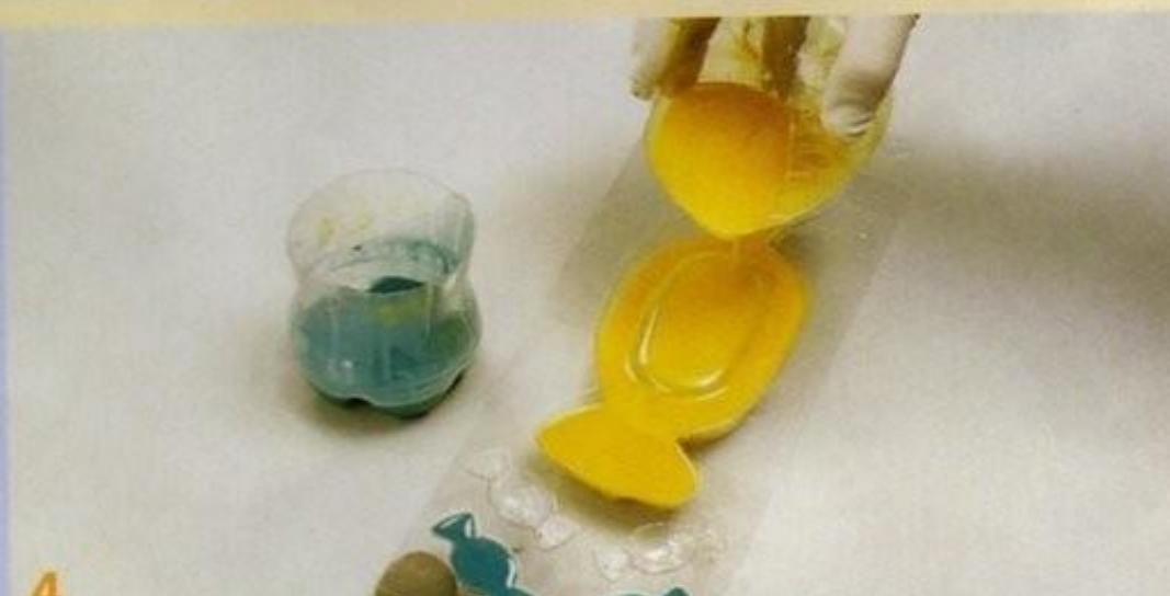
**paso 2** Medir 150 cm<sup>3</sup> de resina y colocarla en el pote de mezcla. Añadir 1,5 cm<sup>3</sup> de catalizador y mezclar bien.
