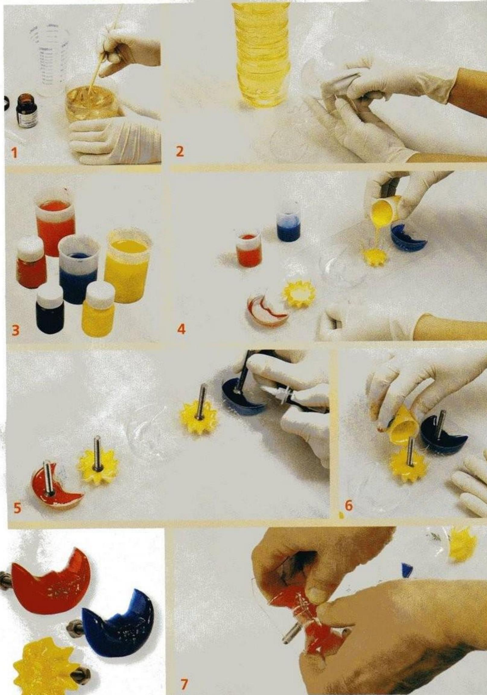
**paso 1** Medir con agua la cantidad de resina como para llenar los moldes hasta la mitad. Colocar el agua en el medidor para conocer la cantidad de resina, colocar dicha cantidad de resina en el pote de mezcla, añadir el catalizador y mezclar bien.
