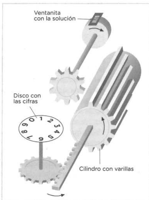
Mecanismos de la máquina aritmética de Leibniz. Era la primera máquina de este tipo que permitía realizar las cuatro operaciones aritméticas básicas.
