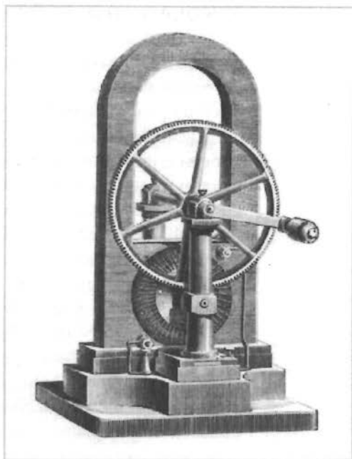
La dinamo desarrollada por el ingeniero belga Zénobe Gramme fue el primer generador eléctrico apto para su empleo en la industria.
