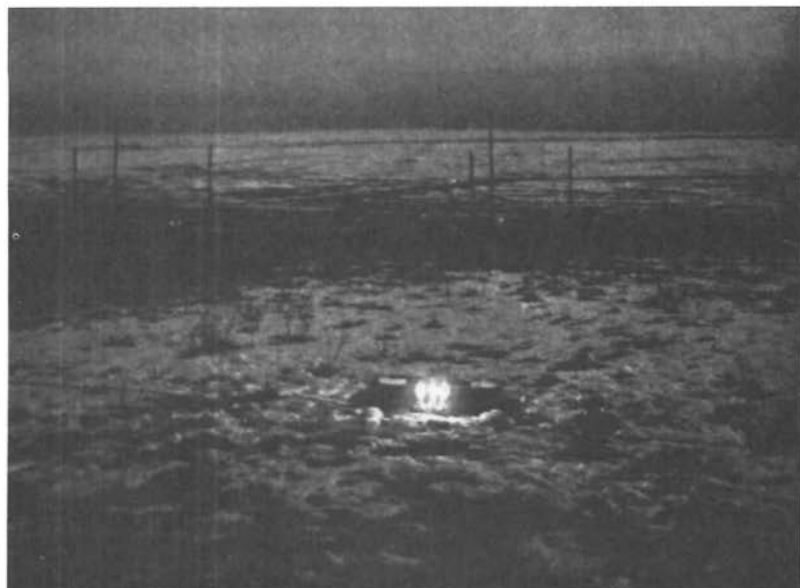
FOTO SUPERIOR: Fotografía del experimento que muestra bombillas incandescentes convencionales que se encienden por efecto de una corriente inducida.
