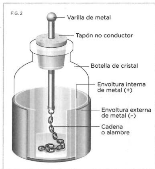
Elementos y estructura de la botella de Leiden.
