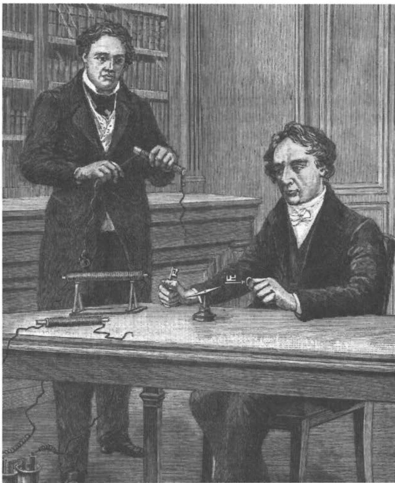
FOTO INFERIOR: 11 de septiembre de 1820. André- Marie Ampère (izquierda) y François Arago repiten el experimento del físico danés Hans Christian Oersted. Arago sostiene dos llaves de conducción cerca de una aguja de brújula y observa la desviación causada. Esto condujo a Ampère a concluir que el magnetismo tenía origen eléctrico.
