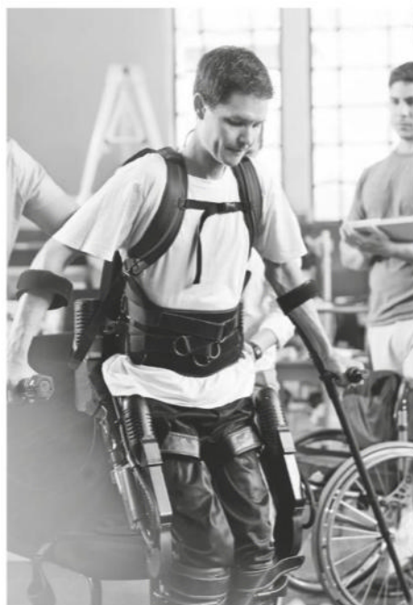
— Exoesqueleto que puede ser accionado por impulsos procedentes de la actividad eléctrica cerebral.
