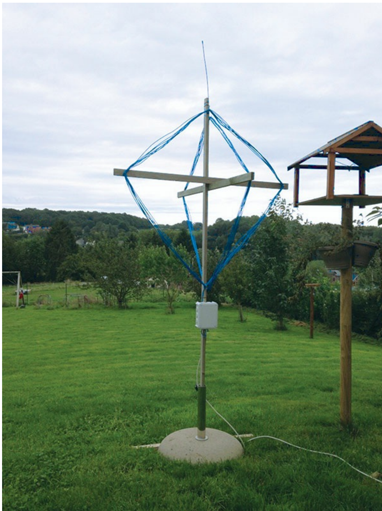
FIGURA II.22. Antena destinada a la recepción de perturbaciones radioeléctricas originadas por rayos.
