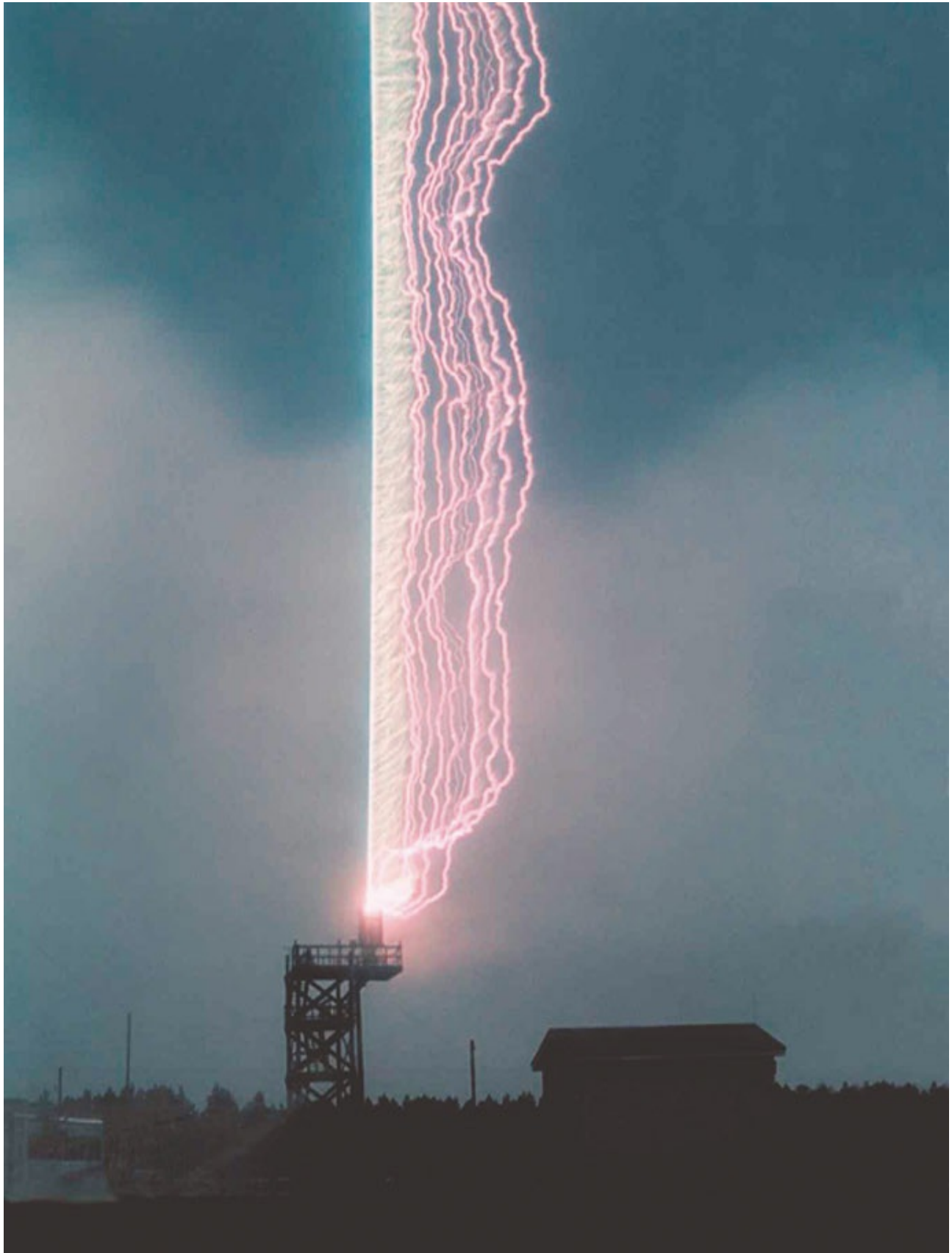
FIGURA II.7. Descargas atmosféricas encarriladas hasta la instalación del ICLRT.
