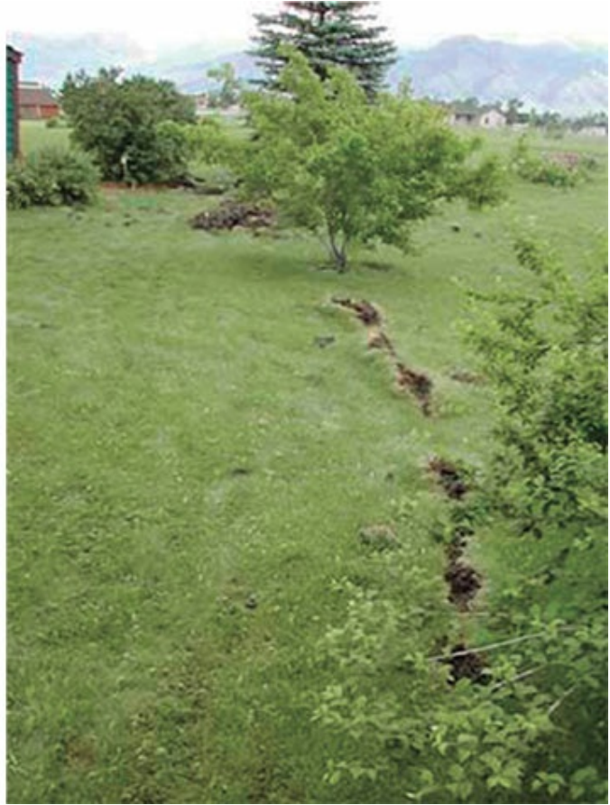
FIGURA IV.4. A la izquierda: huella en forma de fulgurita, dejada por un rayo que alcanzó un cable eléctrico a un metro bajo la superficie de un terreno (imagen: J. C. Diels et al., “Lightning Control with Lasers”). A la derecha: huella en forma de surco en el suelo sobre una tubería metálica soterrada, por la cual se ha propagado una descarga eléctrica atmosférica (imagen: lightningsafety.com ).
