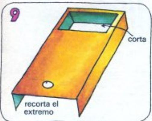
Corta un amplio agujero cuadrado en un extremo de la tapa de la caja. Recorta el otro extremo. Haz un agujero lo suficientemente grande para introducir a través de él una bombilla.
