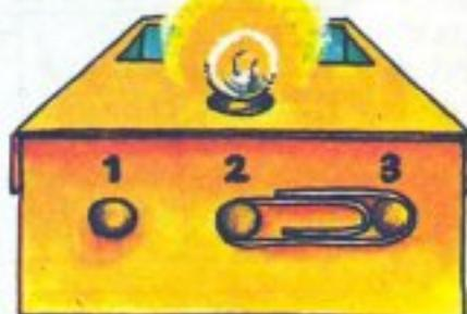
Para comprobar que el transmisor funciona bien, sostén un clip a través de los Terminales 2 y 3 al final de la caja. Presiona el conmutador y la bombilla se encenderá.
