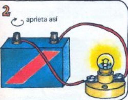
Haz un gancho en la punta del otro cable y engáñchalo al segundo terminal. Se encenderá la luz. Para dejarla encendida enróscala el terminal.
