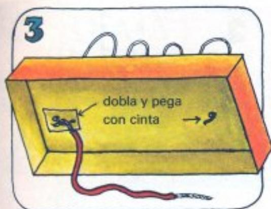
Enrosca la punta de un pedazo de cable, alrededor de la punta de un alambre curvado. Dobra las puntas hacia atrás y pégalas a la tapa con cinta.
