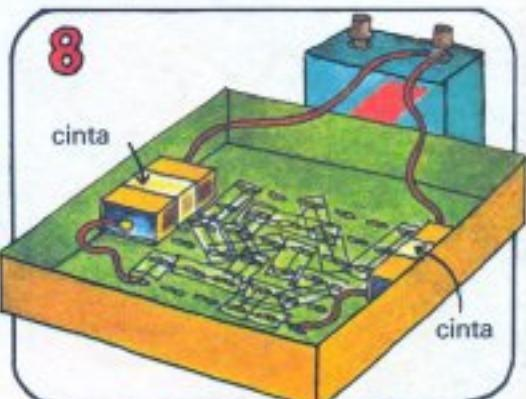
Une un cable de cada portabombillas a un pasador en las esquinas de la tapa. Enrosca los otros dos cables de los portabombillas, alrededor de una terminal de la batería.
