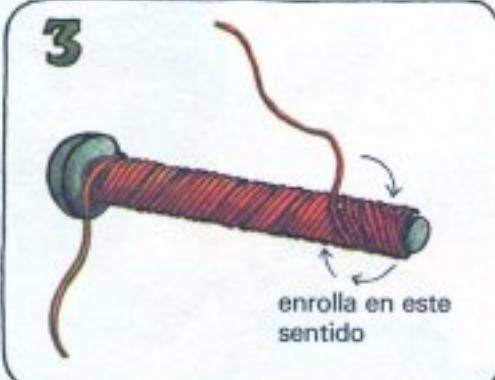
Cuando llegues a la punta del perno o clavo, pon una pequeña pieza de cinta en el alambre. Enrola el alambre a lo largo del perno y vuelve a comenzar. Asegúrate de que el alambre esté muy junto.
