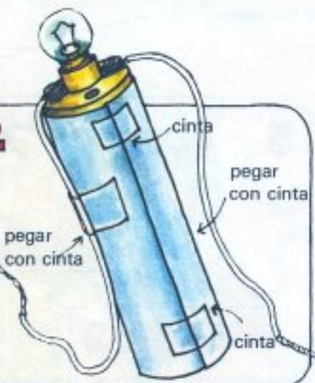
Enrolla la cartulina alrededor del portabombillas, con el cable por fuera, como indica el dibujo. Pega el rollo con la cinta y luego pega el cable al tubo de la cinta.
