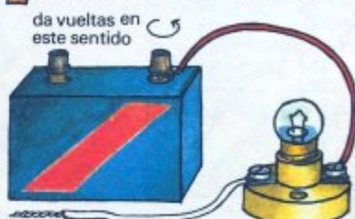
Dobla una punta de alambre en el portabombillas para hacer un enganche. Quita un terminal de la batería y engancha el alambre allí. Enróscalo otra vez.
