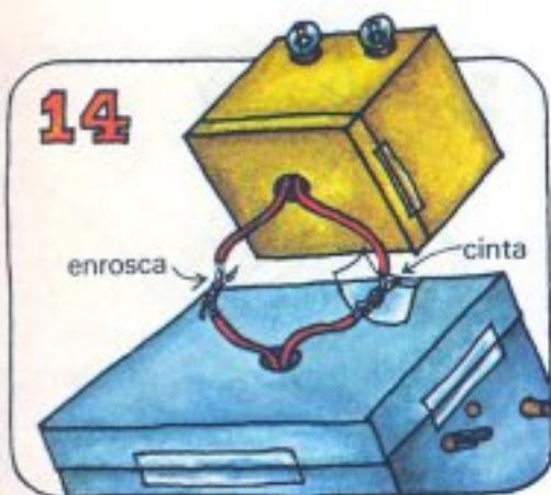
Enrosca un cable de la cabeza alrededor de uno del cuerpo. Pon una pieza de cinta adhesiva alrededor de la parte unida. Haz lo mismo con los dos otros alambres.
