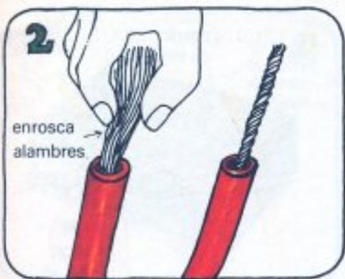
Si tu cable tiene manojos de alambres dentro del plástico, enróscalos para hacer un cable como éste.
