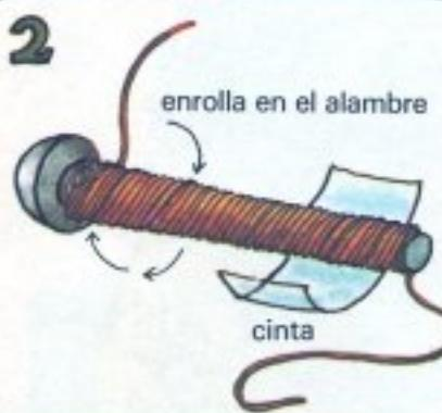
Sostén un extremo del alambre contra el perno o clavo, y enrosca el alambre por todas partes. Asegúrate de que el alambre esté muy junto alrededor del perno o clavo.
