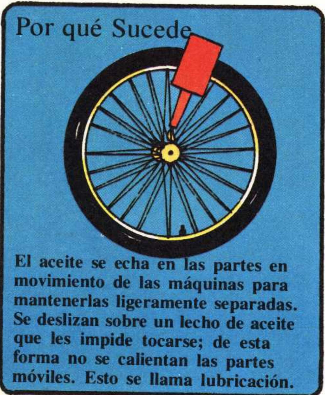
El aceite se echa en las partes en movimiento de las máquinas para mantenerlas ligeramente separadas. Se deslizan sobre un lecho de aceite que les impide tocarse; de esta forma no se calientan las partes móviles. Esto se llama lubricación.
