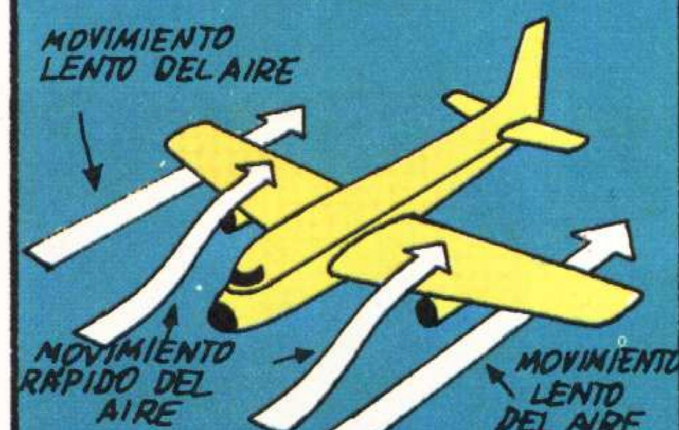
Las alas de los aviones están curvadas en la parte superior. Cuando vuela, el aire de la parte superior se mueve más rápido que el aire de la parte inferior y tiene menos presión. El aire lento de la parte inferior tiene más impulso y lo eleva.
