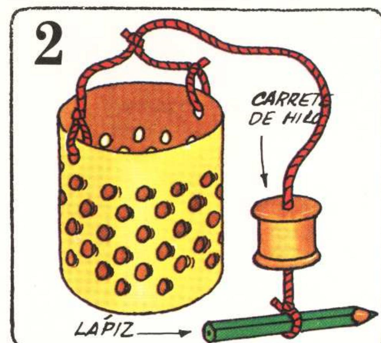
Corta la parte superior de una botella de plástico y sujétala con las cuerdas de la misma forma que en los dibujos 1 y 2 para la Turbina de Agua. Haz muchos agujeros en la botella con las tijeras.
