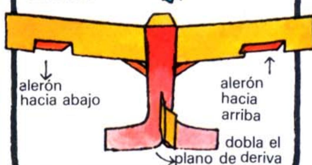
Si tu avión tiene alerones y un plano de deriva, dobla los alerones de la forma usual, y dobla el extremo del plano de deriva dirigiéndolo en la dirección en que quieras que vuela el avión.
