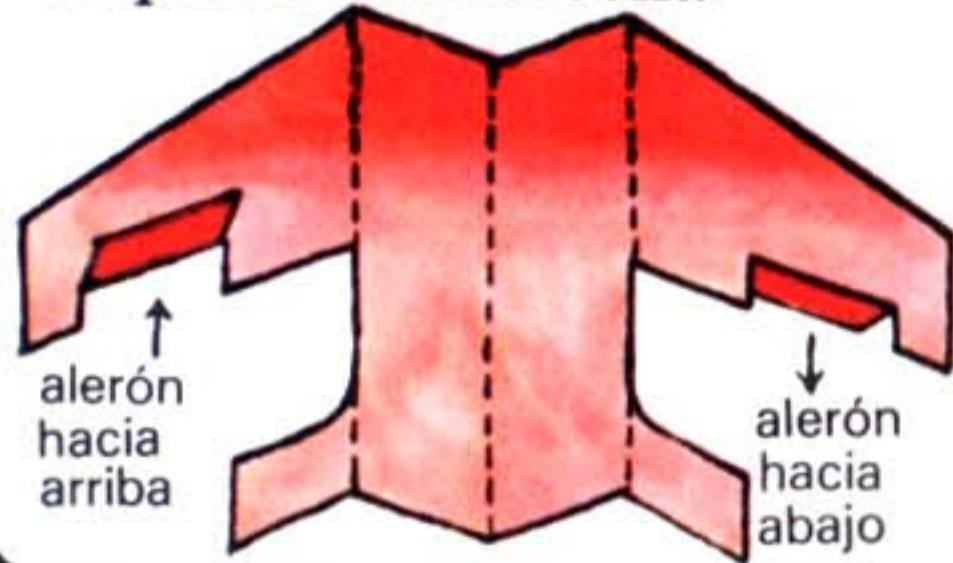
Para hacer girar estos aviones puedes poner alerones en sus alas. Haz dos cortes en cada ala, como se ve. Para hacer volar un avión hacia la derecha, dobla el alerón de la derecha hacia arriba y el de la izquierda hacia abajo.
