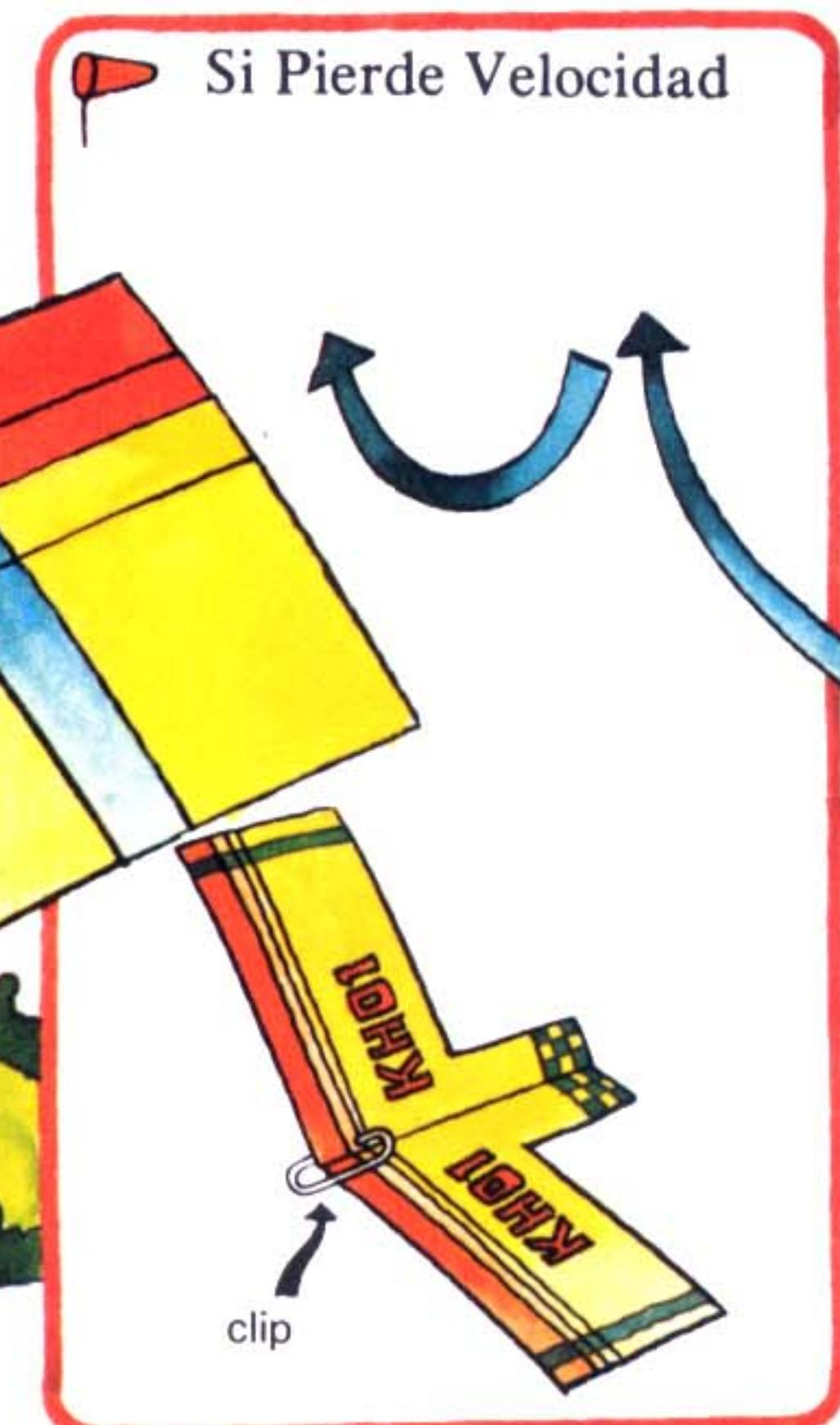
Los aviones pueden volar mal en muchos casos. Algunas veces pierden velocidad. Un avión que pierde velocidad va hacia arriba y hacia abajo repetidamente como éste. Esto es porque el morro no es suficientemente pesado. Coloca un clip en su parte delantera como se ve en el dibujo. Lánzalo. Si todavía pierde velocidad añade otro clip. También puedes probar colocando un pedazo de cinta a lo largo del borde plegado.
