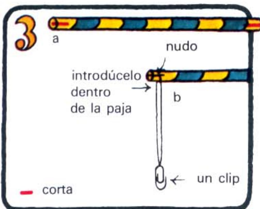
Corta ranuras en los dos extremos de una paja (a). Cuelga un clip de un hilo de 24 centímetros. Haz un nudo en el hilo e introducelo dentro de una de las ranuras de la paja, como se ve (b).
