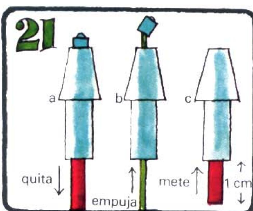
Saca el tubo central de un bolígrafo o lápiz de tinta sintética (a); con un alfiler largo empuja la punta fuera del tubo (b), corta 1 cm. del tubo central y mételo dentro del casco del lápiz.
