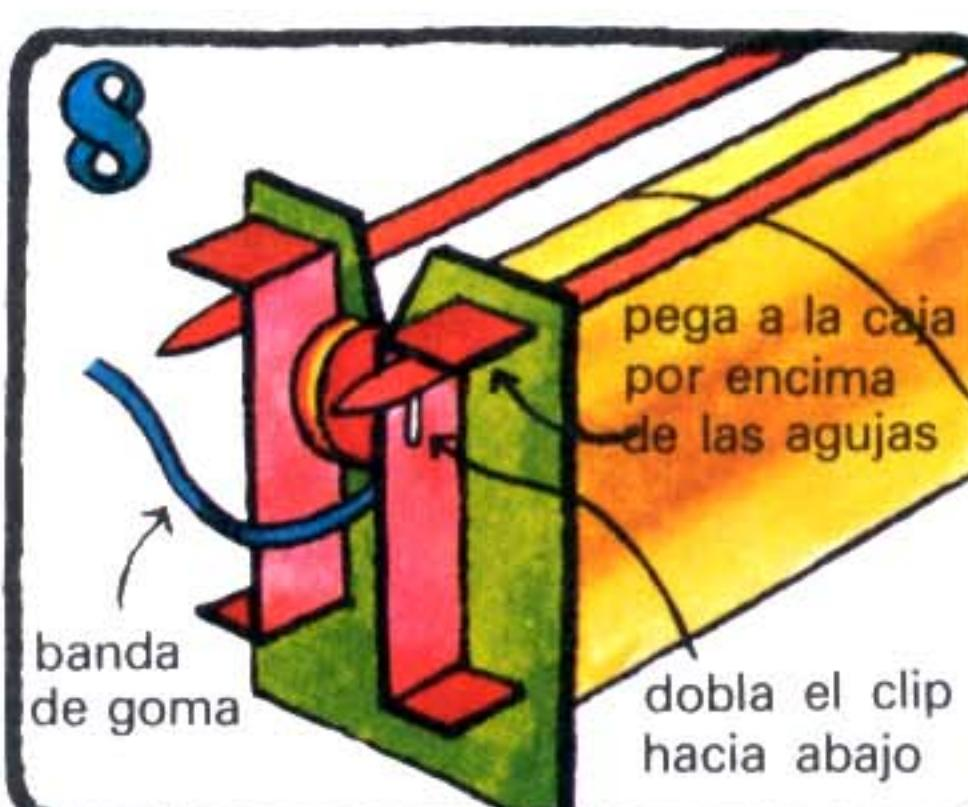
Pega las tiras en la pieza, con el extremo que tiene libre el cabo de la banda de goma, como se ve. Dobla los dos extremos del clip hacia abajo.
