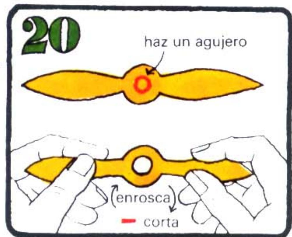
Calca y corta una hélice de cartulina. Haz un agujero con una aguja de hacer calceta donde se ve en el dibujo. Suavemente enrosca una paleta de la hélice en una dirección y la otra en dirección contraria.
