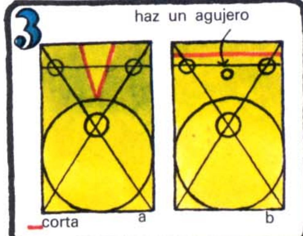
Haz un pequeño corte en la parte superior de una de las piezas (a). Haz un corte recto a través de la otra, justo por encima de los agujeros. Haz un cuarto agujero en esta pieza, como se ve (b).
