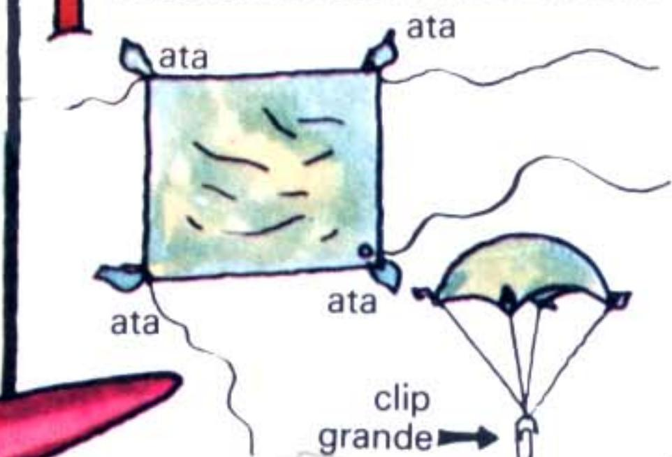
Corta cuatro hilos de 18 cm. de largo. Ata cada uno a cada esquina del plástico. Ata los otros extremos de los hilos a un clip grande.
