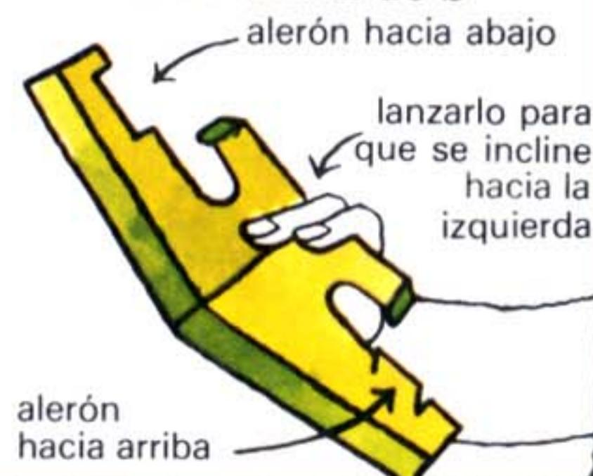
Si encuentras fácil lanzar tu avión para que se incline al virar, prueba haciendo una curva en forma de S. Pon los mandos para que vuele en una dirección, y luego lánzalo inclinado para que gire en la dirección opuesta.
