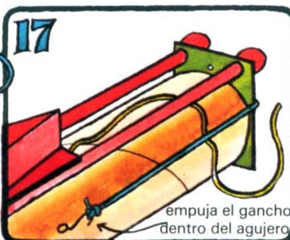
Estira la banda de goma en el otro extremo del lanzador a lo largo del tubo, hasta que esté muy tirante. Haz un agujero en el tubo, dobla el clip para hacer un gancho y engáñchalo dentro del agujero.
