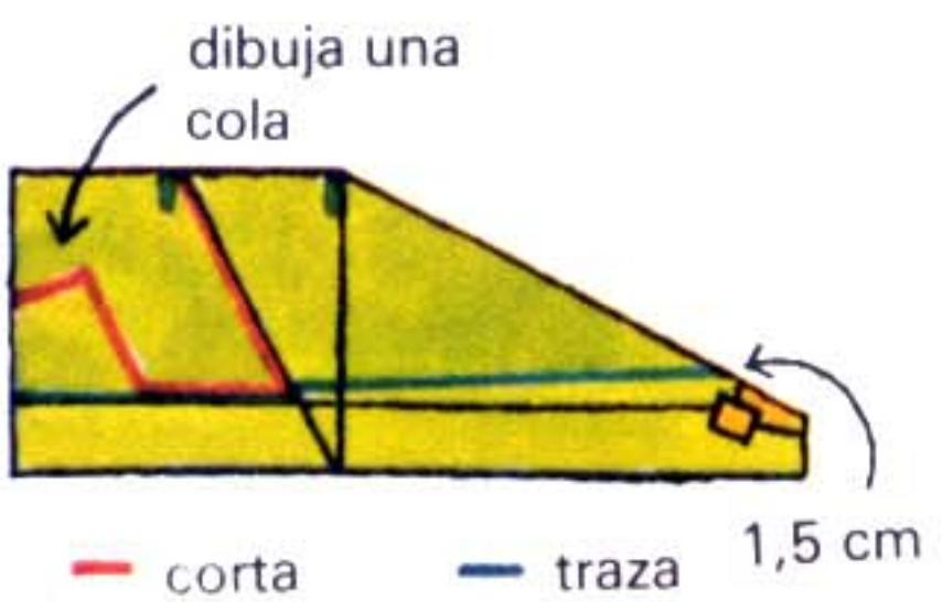
Dibuja una forma de cola y corta el avión, como se ven en el dibujo. Traza una línea a través de las alas, como se ve en el dibujo. Traza otra a través de la cola.
