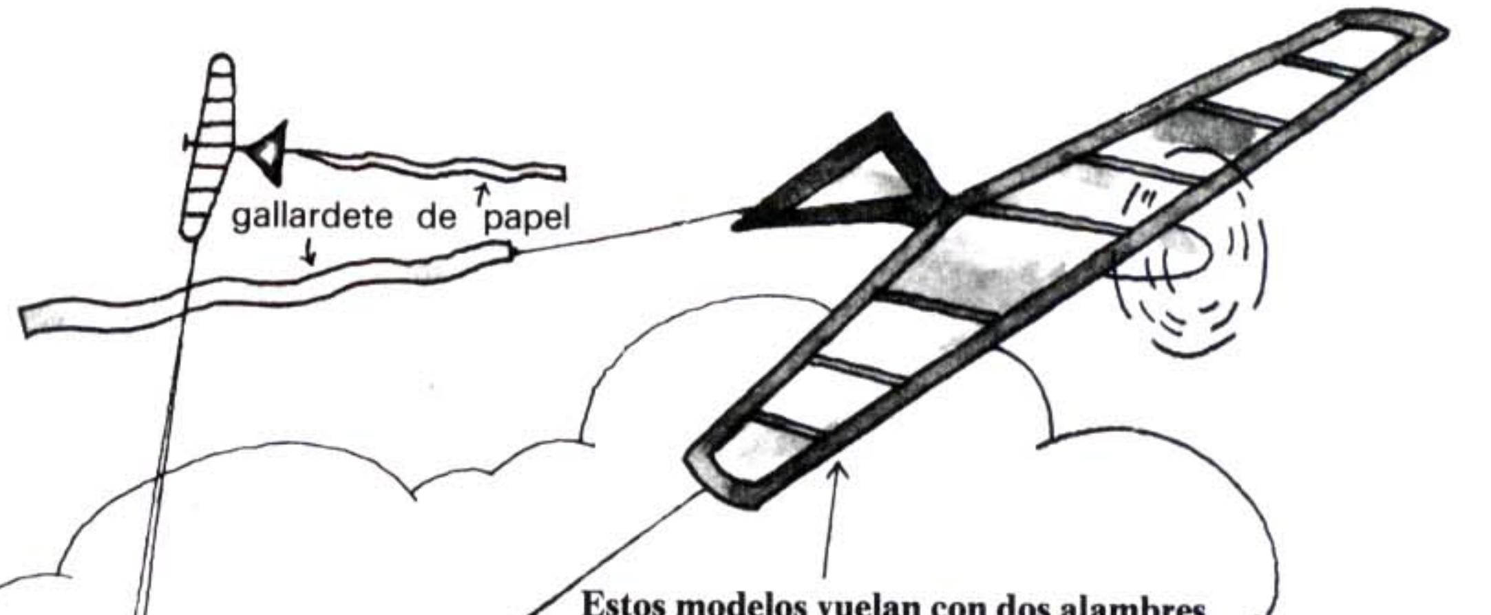
Estos modelos vuelan con dos alambres de acero que les controlan de 15 m. de largo. Los dos hombres sosteniendo los alambres, intentan cortar los gallardetes del otro modelo. Estos modelos pueden volar a 90 millas por hora.
