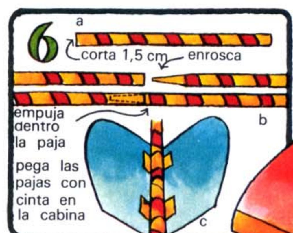
Corta el extremo de una paja (a), enrosca el extremo cortado e introducelo en otra para hacer una más larga (b), pega con cinta la parte de en medio de ella, en la cabina (c).
