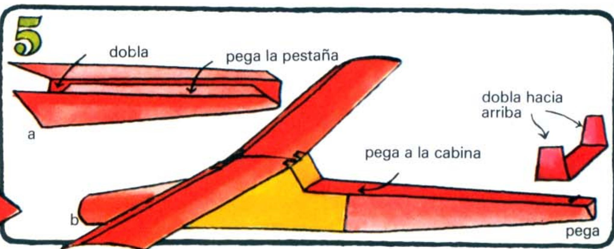
Calca y corta un fuselaje de papel. Doblalo como se ve. Pon pegamento en la pestaña y júntalo (a). Calca y corta una cola de papel. Dobla los lados de la cola hacia arriba, donde se ven en el dibujo.
