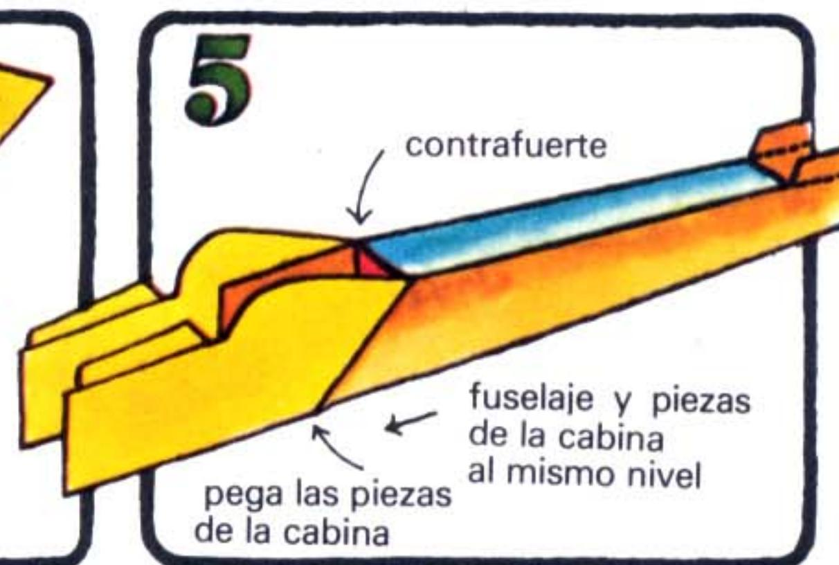
Pega las piezas de la cabina a los lados del fuselaje. Haz esto sobre una superficie plana, para que el inferior de cada cabina quede en línea recta con el fuselaje.
