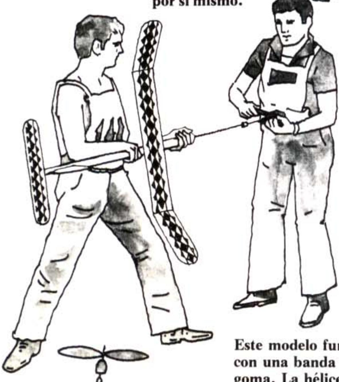
Este modelo funciona con una banda de goma. La hélice funciona con una banda de goma fuertemente enroscada.
