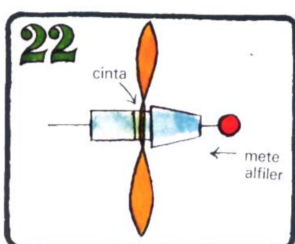
Empuja el casco a través del agujero en la hélice, como se ve. Pega la hélice con cinta al casco. Mete el alfiler a través del agujero en medio del casco del lápiz o bolígrafo.
