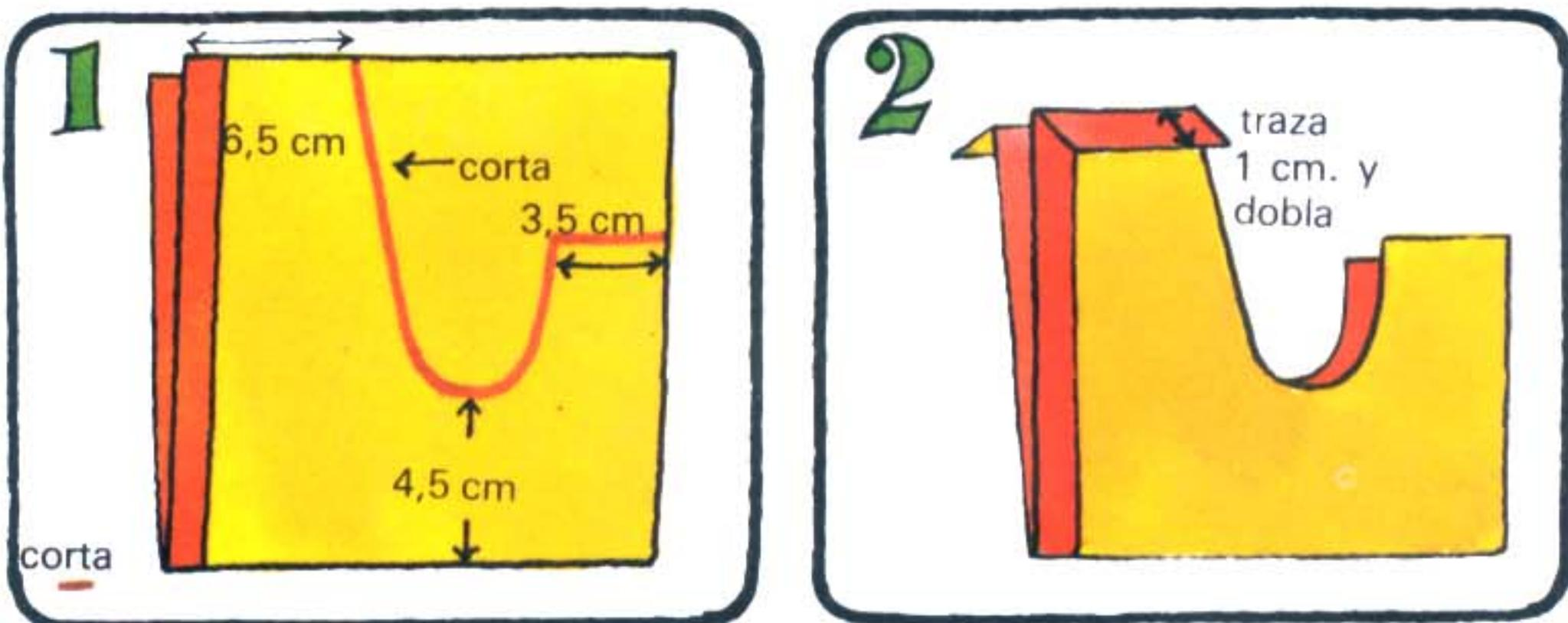
Sigue las instrucciones de los cuatro primeros dibujos del Prototipo KH01. Luego dobla el papel por la mitad con el borde plegado por la parte de afuera. Dibuja y corta la forma del planeador, como se ve en el dibujo.
