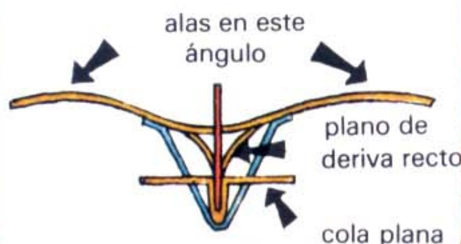
El avión debe aparecer así, si lo sostienes delante de ti. El plano de deriva debe apuntar recto hacia arriba y las partes de la cola deben de estar planas. Las alas deben estar en ángulo.
