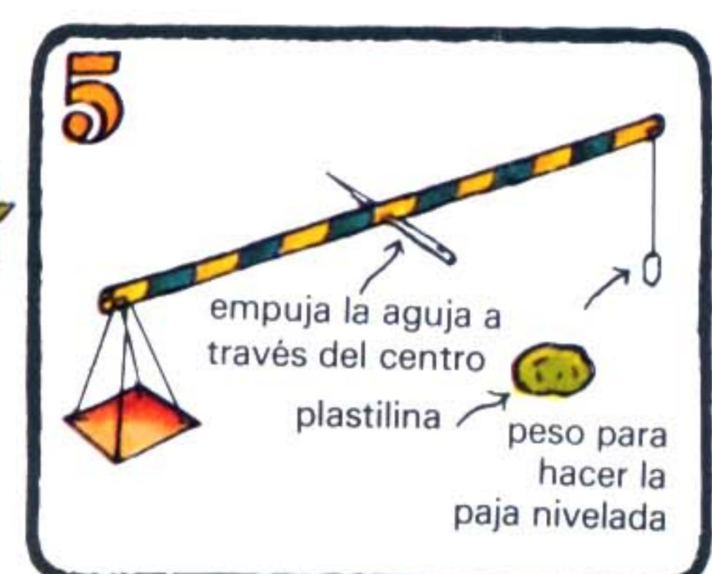
Empuja la aguja a través del centro de la paja. Sostén la aguja y comprueba si la paja queda nivelada. Pon un peso en el clip o cartulina hasta que ambos lados se balanceen bien.
