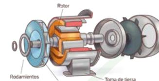
La inducción electromagnética se aprovecha para generar electricidad a partir del movimiento de un imán que produce un campo electromagnético.
