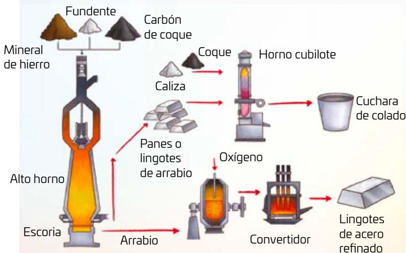
Una vez hecha la fundición del mineral, gracias a la mezcla de fundente y carbón, se obtiene el arrabio el cual se vuelve a fundir en un horno de cubilote. El acero se obtiene mezclando el arrabio líquido con chatarra y mineral de hierro en un mezclador. En los altos hornos se producen los distintos tipos de acero que existen, según las necesidades. Este proceso se llama siderúrgico.
